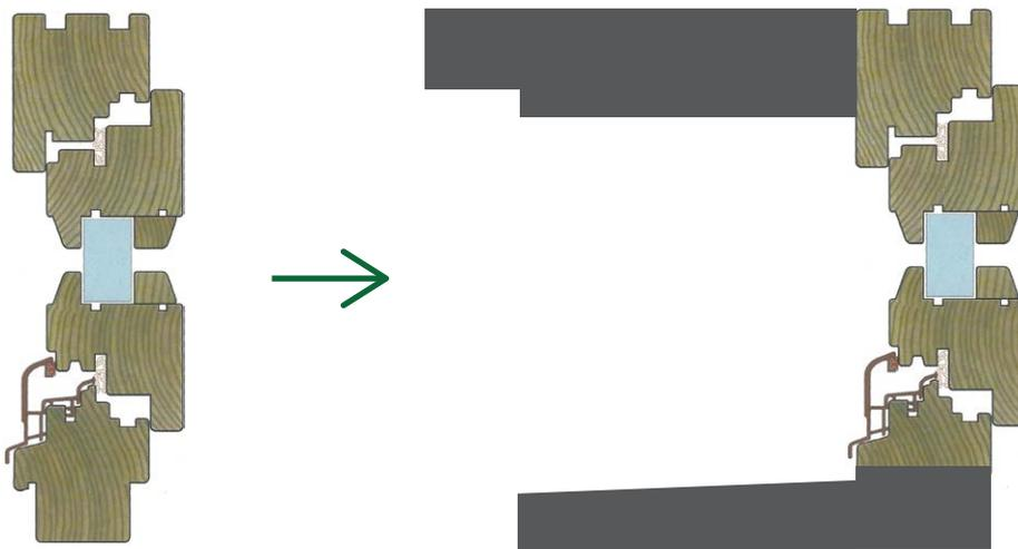
Athos fertigt Fenster und Türen mit der Möglichkeit für Rahmenerweiterung. Die Rahmenerweiterung wird üblicherweise verwendet, um die Dicke der Wand abzudecken, damit der Rahmen zum Wetterschutz weiter in das Gebäude hinein platziert werden kann. Ferner wird es verwendet, wenn ein Insektenschutzgitter oder ein Verschluss vorhanden ist. In der Regel hat ein Rahmen eine Breite von 140 mm, 190 mm oder größer.
